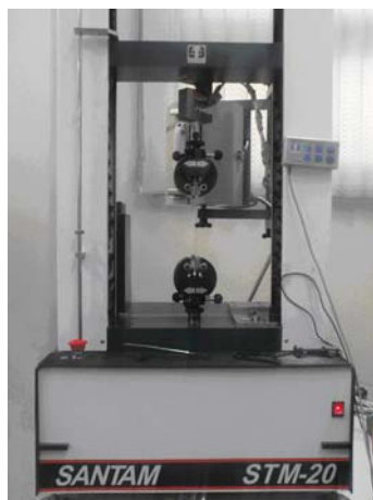
شکل ۳- دستگاه کشش مورد استفاده
