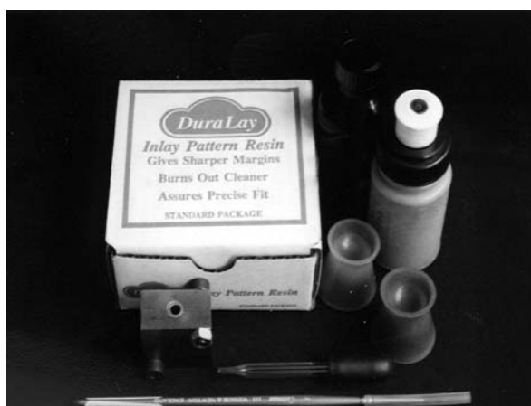
شکل ۱ - مواد و وسایل لازم جهت تهیه الگوی آکرلی Duralay
